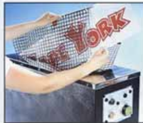
3. Verdichten im Sealbad wie beim GEDAKOP-System
